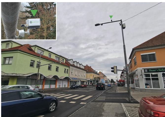
Im Rahmen dieser neuen Partnerschaft setzt ALPLab das Helius Smart LiDAR System von Cepton zur Erfassung von 3D-Verkehrsdaten in Echtzeit ein. Die LiDAR-Daten unterstützen das Training von KI-Algorithmen, die für szenariobasierte Tests von ADAS- und AV-Funktionen verwendet werden. Darüber hinaus dienen die gesammelten Daten zur Vorhersage von Fahrzeugtrajektorien an Kreuzungen sowie zur Analyse von Verkehrsdaten für die Optimierung des Verkehrsflusses.
